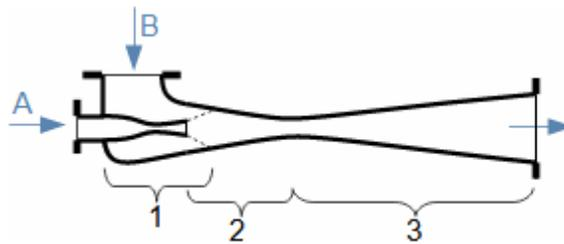
**20:** General diagram of ejector or injector
