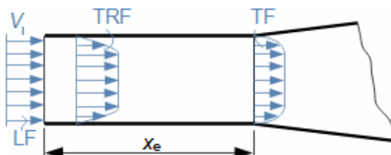
11: Vývoj rychlostního profilu v hrdle difuzoru
